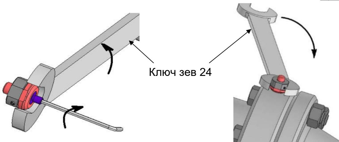
Рисунок 5. Вкручивание шпильки в основание      Рисунок 6. Установка монтажного комплекта на агрегат
