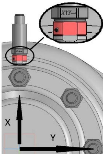
Рисунок 7. Установка измерителя вибрации и совмещение осей измерения
